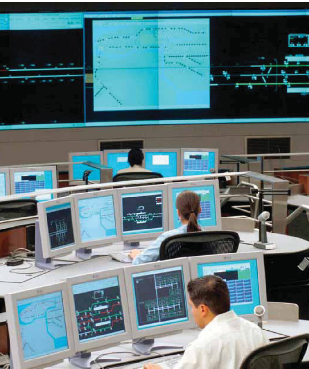
Systém Trainguard: Vyše storočné metro v New Yorku zvýšilo prepravnú kapacitu skrátením intervalu medzi vlakmi na 85 sekúnd. Systém od Siemensu je nasadený aj v Paríži, Budapešti, Barcelone a v Číne.
