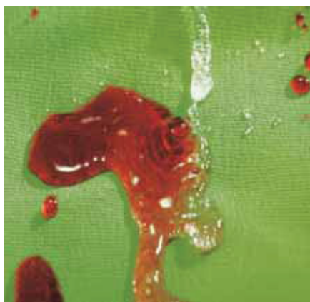
NanoSphere: Technológia dáva plošným textíliám neobyčajnú schopnosť odpudzovať vodu a odolnosť proti znečisteniu.
